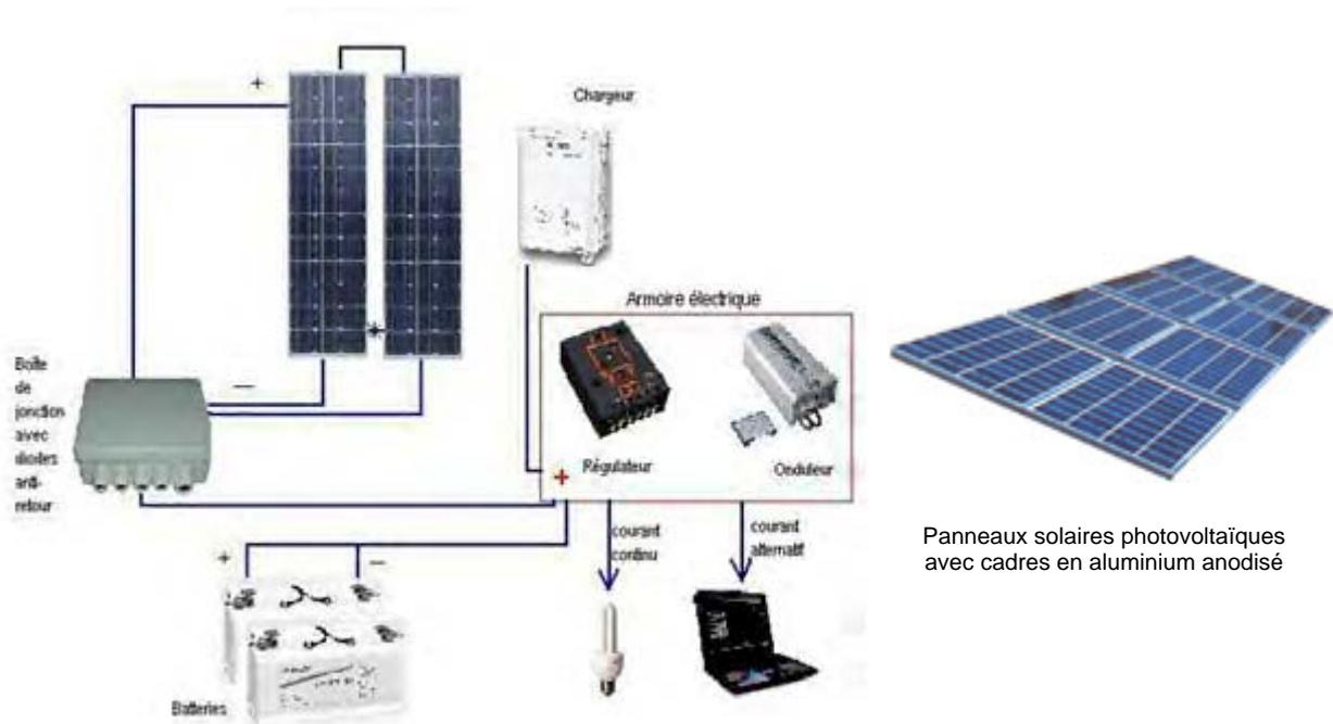
Principe de fonctionnement d'une installation de panneaux solaires photovoltaïques
