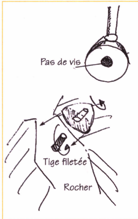
5 - L'embout est vissé à la roche, pour résister à l'arrachement
